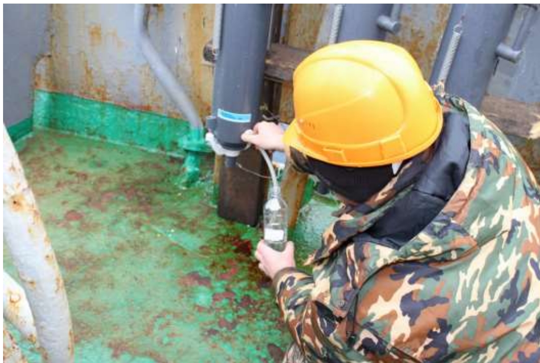
Рисунок 2.4.2 – Отбор проб воды для гидрохимических исследований
