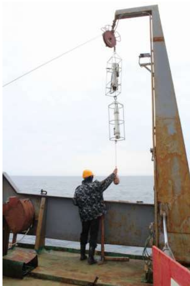
Рисунок 2.2.2 – Спуск гидрологического зонда в воду для проведения измерений
