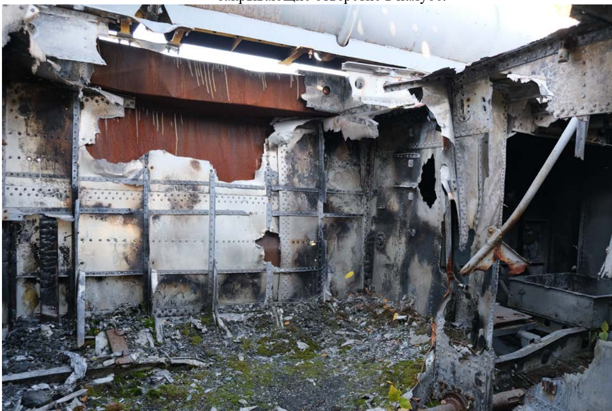
14. Вид борта катера изнутри, поздние заделки утрат алюминиевой обшивки железным листом.
