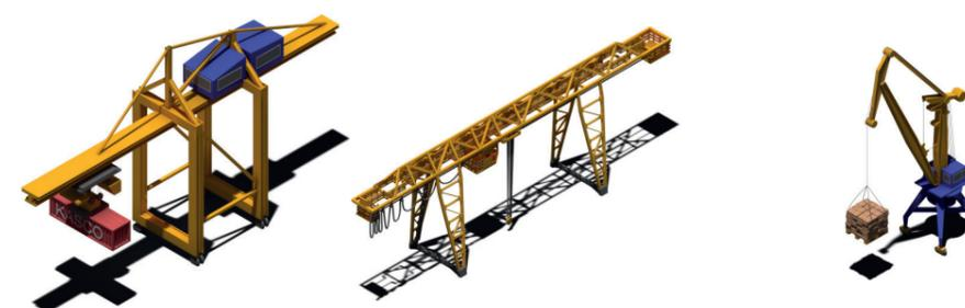
На контейнерном терминале - 2 крановых перегружателя СРР грузоподъемностью 30,5 т. и один козловой кран МККС-42К грузоподъемностью 30,5 т.
